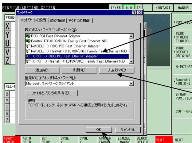
TCP-IP Einstellungen für das Netzwerk ( RDC PCI Fast Ethernet Adapter )
