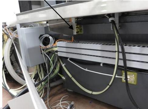
Stroke End Switch +X (MV/MP2400)
