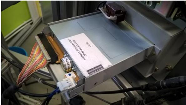
Das Originallaufwerk ist entweder mit 4 Schrauben von der Seite oder von unten befestigt.
