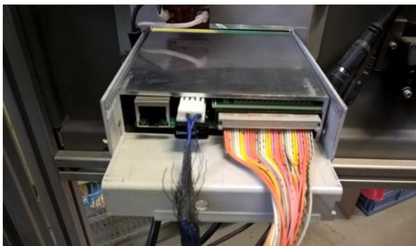
Schliessen Sie das Datenkabel und die NEUE Stromversorgung an.
